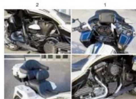
1: デジタルメーターでまとめたインターパネルまわり。ナビはiPadを使用。2&3: カバー類やステップ、エンジンのフィンに至るまで、あらゆるところにダイヤモンドカットが施されている。車体が大きいので取り回しやすさを考慮し、マンパのバックギアを装備。4: バックレスト付きのツアーバックはタンデムする時の仕様
